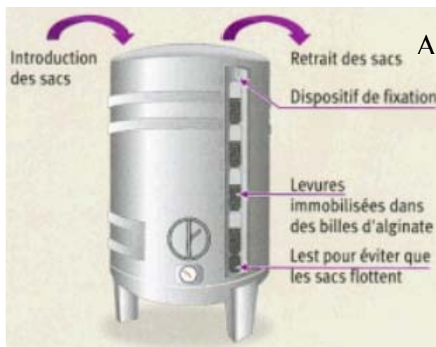
Figure 4. Les levures encapsulées sont placées dans les sacs de Nylon, la longueur des sacs a été adaptée à la hauteur de la cuve de fermentation. Un lest est fixé à l'extrémité inférieure des sacs, afin d'éviter qu'ils ne flottent. Les sacs sont suspendus à la partie supérieure de la cuve de fermentation (A). Avant introduction dans la cuve de fermentation, les sacs contenant les billes sont réhydratés pendant 30 minutes dans une solution sucrée avec 40 g/L de saccharose afin de réactiver les levures (B).
