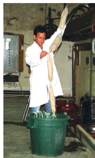
Figure 4. Les levures encapsulées sont placées dans les sacs de Nylon, la longueur des sacs a été adaptée à la hauteur de la cuve de fermentation. Un lest est fixé à l'extrémité inférieure des sacs, afin d'éviter qu'ils ne flottent. Les sacs sont suspendus à la partie supérieure de la cuve de fermentation (A). Avant introduction dans la cuve de fermentation, les sacs contenant les billes sont réhydratés pendant 30 minutes dans une solution sucrée avec 40 g/L de saccharose afin de réactiver les levures (B).
