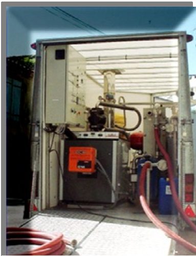
Abb.4: Technische Ausrüstung für die Flash-Pasteurisierung
