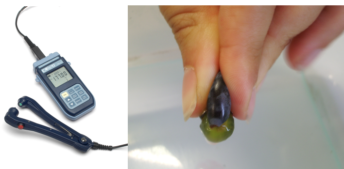
Unité de contrôle et pince pour la mesure de l'indice de maturité phénolique (à gauche) et phase de préparation de la pellicule à analyser (à droite)
