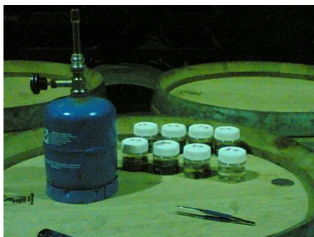
3/ ensemencement des copeaux dans le milieu Sniff'Brett puis incubation
