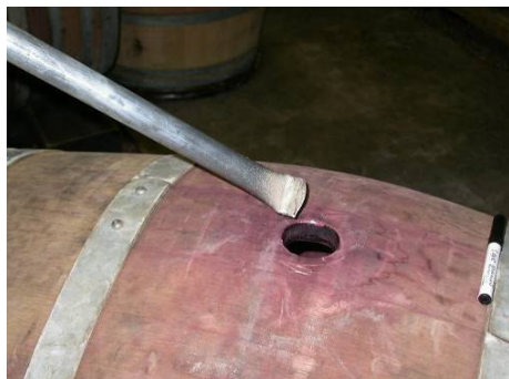
Photos 4 à 9 : procédé de contrôle microbiologique des fûts avec Sniff'Brett
