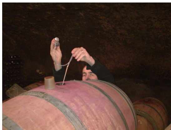
Photos 1, 2 et 3 : kit de prélèvement microbiologie pour les fûts
