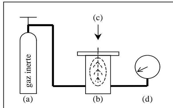
**Figure 2** *Principe de fonctionnement d'une chambre à pression.*
