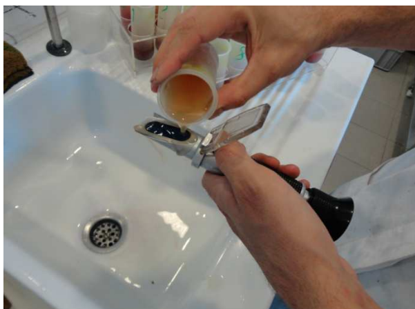
Foto 7. Misurazione degli zuccheri nel mosto estratto dai campioni d'uva con l'utilizzo del rifrattometro
