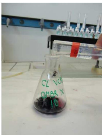
Foto 9. Addizione di 80 ml di metanolo in beuta contenente le bucce ripulite
