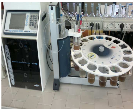
Foto 8. Misurazione del pH e dell'acidità totale con metodiche automatizzate
