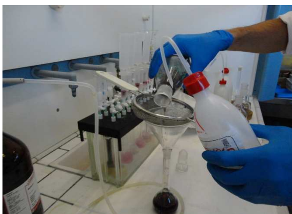
Foto 11. Trasferimento soluzione in matraccio da 100 ml
