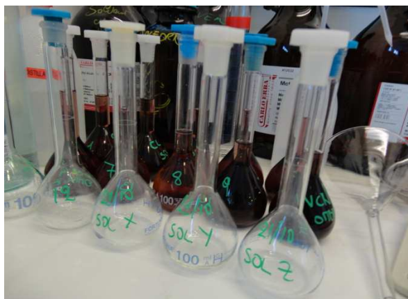
Foto 12. Preparazione dei matracci contenenti 100 ml di soluzione metanolica
