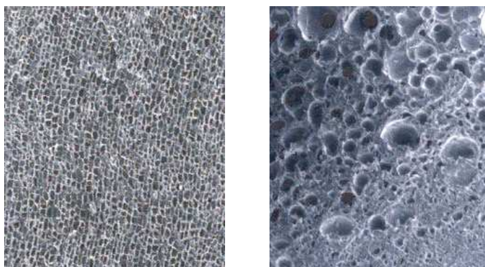
Figura 2. Cellulazione di un tappo in sughero (a sinistra) e di un tappo sintetico (a destra)
