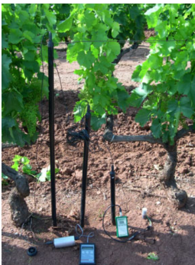
Umitrone nel sito di Vidauban (misura della forza di ritenzione dell'acqua nel suolo)
