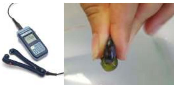
Unidade de controlo e pinça para a medição do índice de maturação fenólica (esquerda) e fase de preparação da película a analisar (direita)
