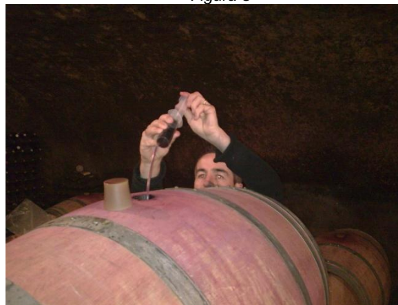
Figuras 1, 2 e 3: kit para retirar amostras microbiológicas de barricas
