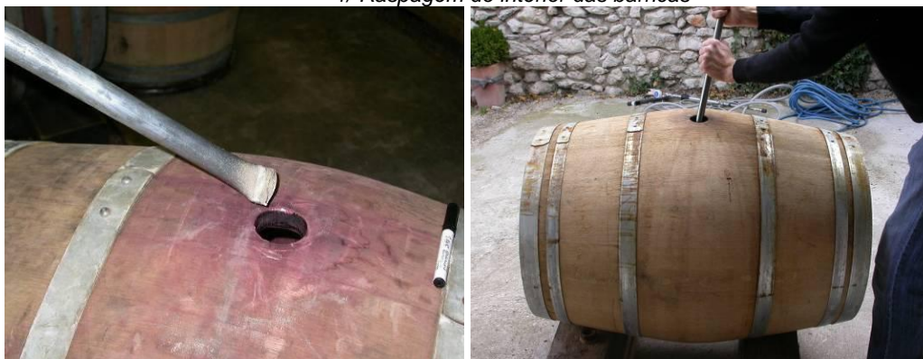
Figura 4 a 9 : Procedimento de controlo microbiológico das barricas com Sniff'Brett
