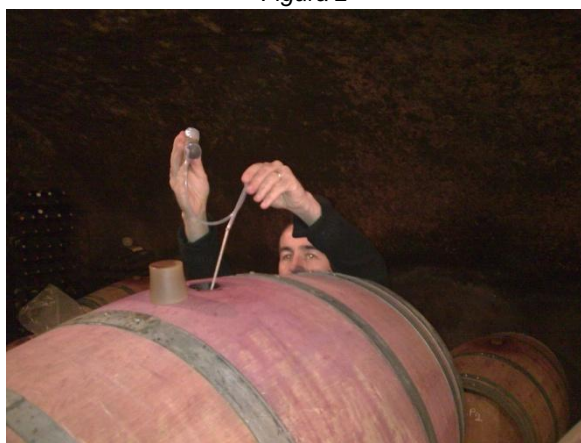
Figuras 1, 2 e 3: kit para retirar amostras microbiológicas de barricas
