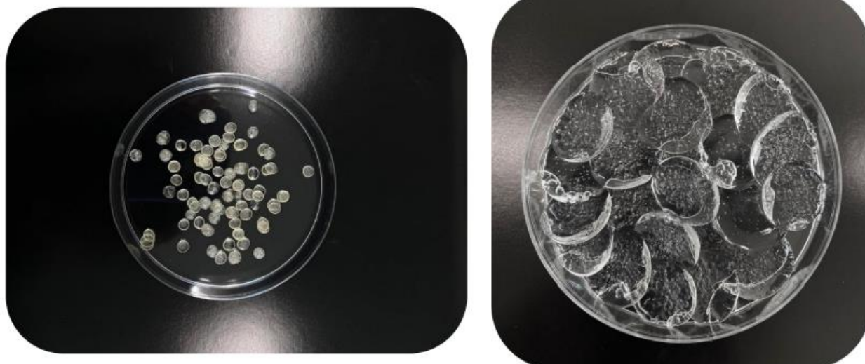
Fig. 1: a sinistra idrogel a base di poliacrilato di potassio nella loro forma disidratata, a destra gli stessi idrogel nella loro forma idratata
